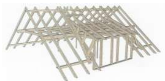
Satteldach/Pfettendach 45° mit Doppelgaube
