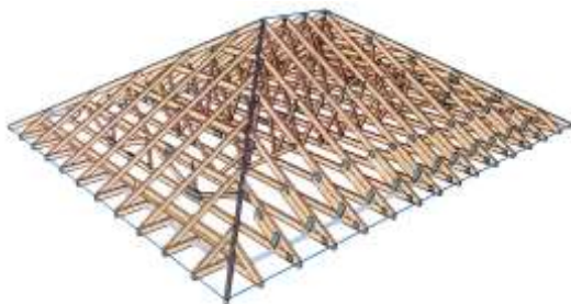
Fachwerkbinder - Walmdach bis 28° mit Untergurt
