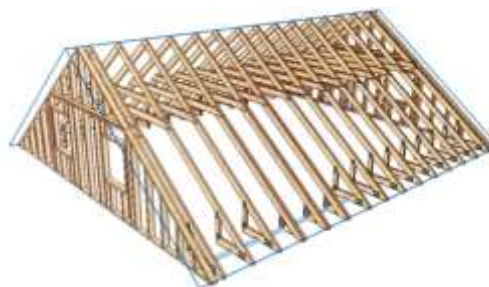
Studiobinder - Satteldach 35° auf Betondecke
