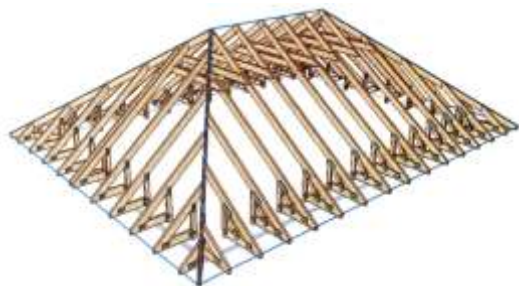
Studiobinder - Walmdach 35°/40° auf Betondecke
