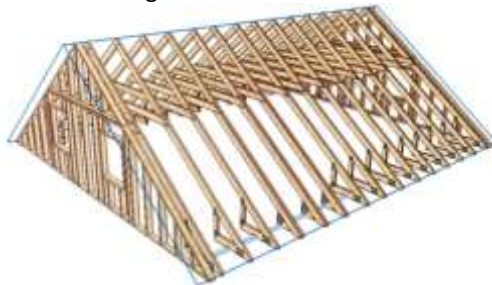
Studiobinder - Satteldach 35° auf Betondecke
