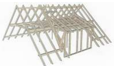
Satteldach/Pfettendach 45° mit Doppelgaube
