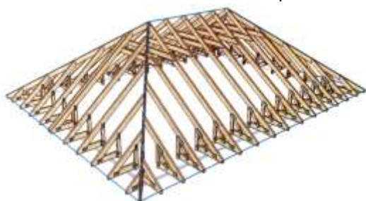
Studiobinder - Walmdach 35°/40° auf Betondecke
